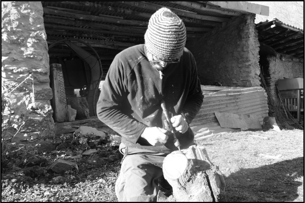
Perçage à la chignole de feuilles en laiton (Photo Frédéric Bonora)
